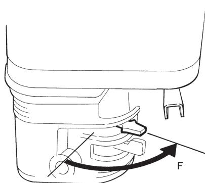
7. Дайте двигателю поработать несколько минут. Крепко возьмитесь обеими руками за рукоятку управления устройством. Не отпуская рукоятку управления устройством, увеличьте частоту вращения двигателя рычагом дросселя (B), находящимся справа.
