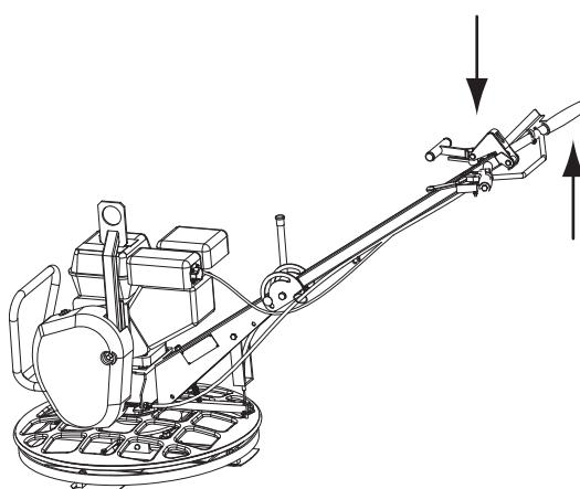
**Регулировка углового положения лопастей.**
