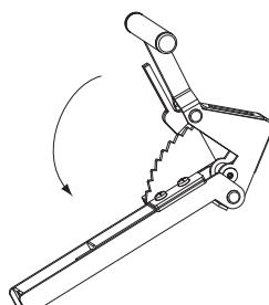
Машина BG240TP оборудована ручкой для плавной регулировки углового положения лопастей.
