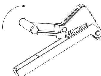
◆ Чтобы уменьшить угол, под которым расположены лопасти, нужно перемещать рычаг ступенчатой регулировки от себя.
