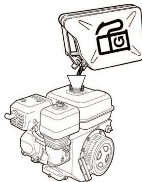
4. Нельзя переполнять топливный бак. Топливо в баке движется и может поэтому оказаться выше уровня крышки бака, что приведет к разбрызгиванию топлива, если крышка будет открыта. Этого можно избежать, если открывать крышку топливного бака только тогда, когда устройство наклонено и крышка находится в самой верхней точке бака.
